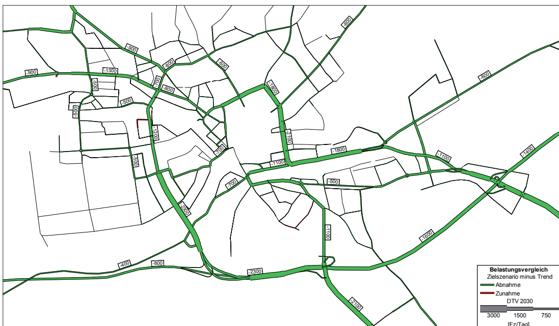
Abb. 22: Belastungsvergleich Zielszenario mit Trendentwicklung DTV 2030, Ausschnitt Stadt Solothurn (Karte: Roland Müller Küsnacht AG, April 2012)
